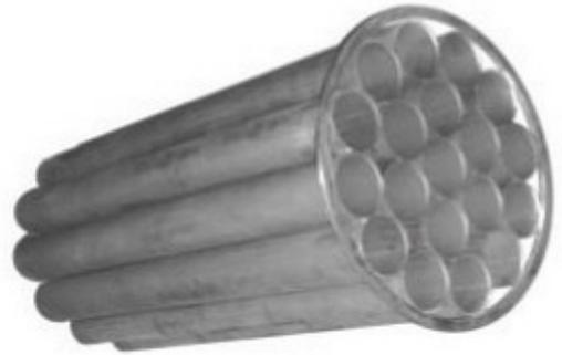
Существенное значение в конструкции струевыпрямителя имеет параллельность трубок, как между собой, так и относительно оси трубопровода, т.к. при несоблюдении этого требования струевыпрямитель сам может стать источником закручивания потока.
