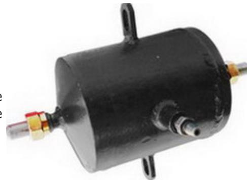
Сосуды разделительные (СР) предназначены для защиты внутренних полостей датчиков от непосредственного воздействия измеряемых агрессивных сред путём передачи давления через разделительную жидкость.
