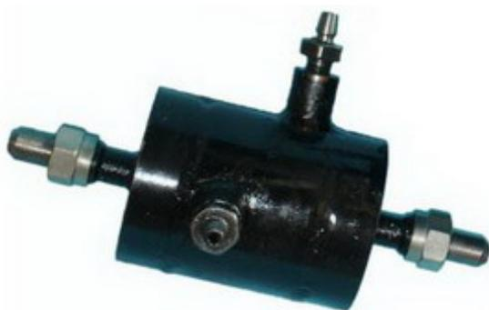
Сосуды уравнильные конденсационные (СК) предназначены для поддержания постоянства и равенства уровней конденсата в соединительных линиях, передающих перепад давлений от диафрагмы к датчикам разности давлений, при измерении расхода пара.
