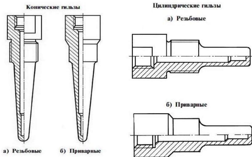
Пример обозначения при заказе: **ГТ-701-М33x2-М20x1,5-12Х18Н10Т,**
