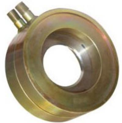
ДКС устанавливается во фланцах трубопровода, применяется при диаметре условного прохода от 50 до 500 мм включительно и избыточном давлении в трубопроводе не более 10 МПа;
